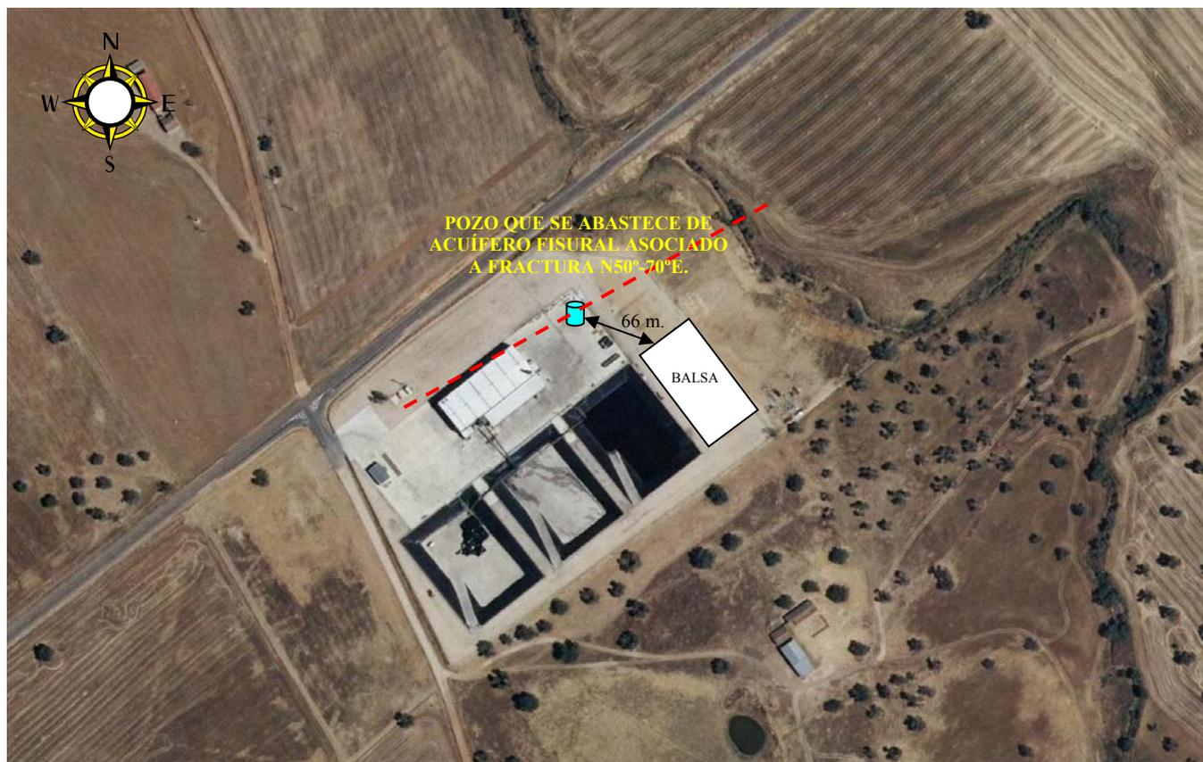
Se trata de un sondeo de 130 metros de profundidad que capta un caudal de 500 l/h (0,13 l/s), el nivel piezométrico se sitúa en torno a los 120 metros de profundidad, el agua se captó en torno a esa profundidad asociada a una zona de fracturación con arenización de las pizarras.
